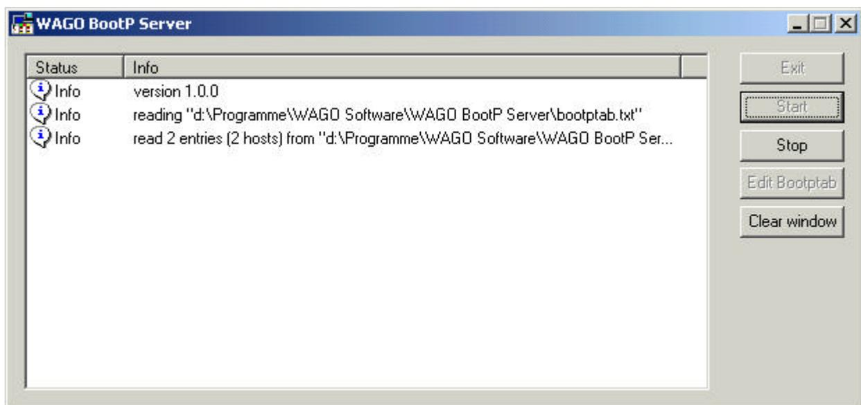
6. Hardware-Reset am Feldbus-Controller ausführen (Stromzufuhr unterbrechen), kurz warten, dann "STOP" und "Exit" im WAGO Bootp-Server.
